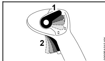
Der Gashebel (2) kann stufenlos arretiert werden:
