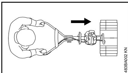
Mit dem MultiMotor mit Moosentferner MF-MM wird vorwärts gearbeitet.
