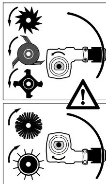
Bei Metall-Werkzeugen das Getriebe so positionieren, dass die Welle unterhalb vom Schaft liegt.
