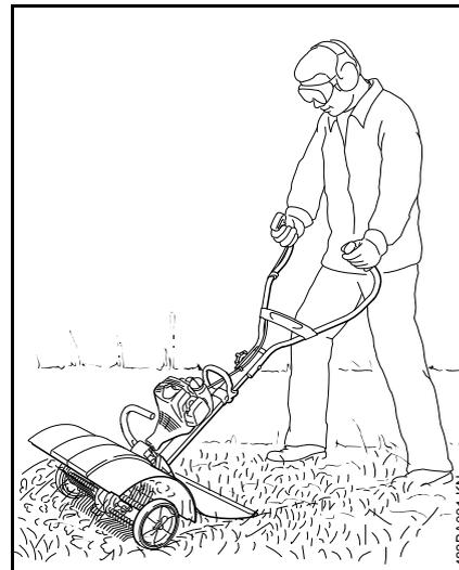
Das MultiWerkzeug Moosentferner MF-MM dient zum Entfernen von altem, vertrocknetem Schnittgut sowie Moos, Gras- oder Wurzelresten aus der Rasenfläche.
