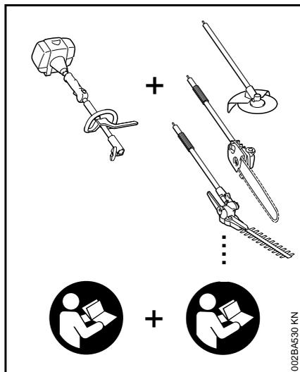
Beim STIHL KombiSystem werden unterschiedliche KombiMotoren und KombiWerkzeuge zu einem Motorgerät zusammengeführt. Die funktionsfähige Einheit von KombiMotor **und** KombiWerkzeug wird in dieser Gebrauchsanleitung Motorgerät genannt.
