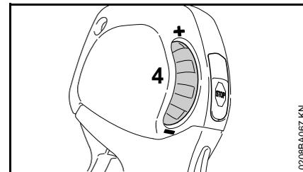
Mit dem Stellrad (4) kann der Gashebelweg und damit der Bereich für die Motordrehzahl stufenlos zwischen Leerlauf und Vollgas eingestellt werden:
