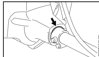
Zwischen Motoreinheit und Schaft ist ein Gummielement zur Schwingungsdämpfung eingebaut. Bei erkennbarem Verschleiß oder spürbar ständig erhöhten Vibrationen prüfen lassen.
