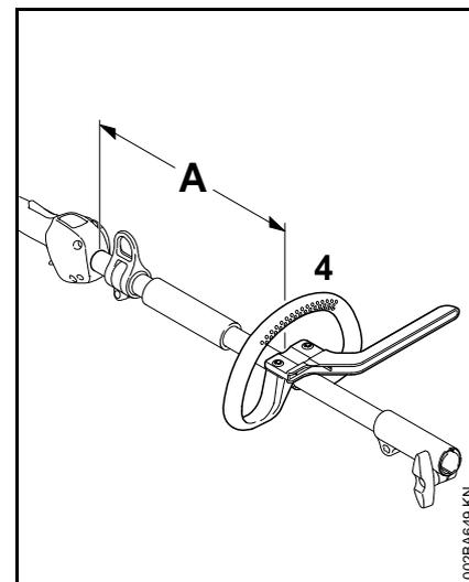
Durch Ändern des Abstands (A) kann der Rundumgriff in die für die Bedienungsperson und den Anwendungsfall günstigste Lage gebracht werden.
