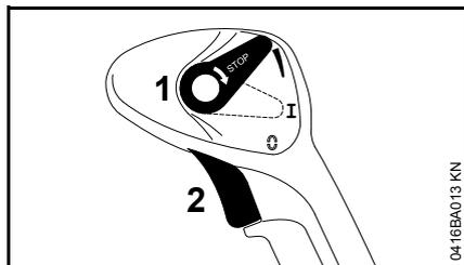
Der Gashebel (2) kann stufenlos arretiert werden.
