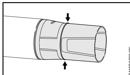
Während der Arbeit wird der vordere Teil der Düse durch schleifenden Kontakt mit dem Boden abgenutzt. Die Düse ist ein Verschleißteil und muss beim Erreichen der Verschleißmarkierung ersetzt werden.
