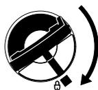
Tankverschluss mit Klappbügel (Bajonettverschluss) korrekt einsetzen, bis zum Anschlag drehen und den Bügel zuklappen.
